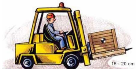
**Sobrecarga:** se a carga pesa demasiado, o empilhador pode virar-se. Se tiver de mover uma grande carga, é melhor formar com ela vários lotes para os mover em separado. Amarrar e calçar as cargas sem ultrapassar a carga máxima prevista.
