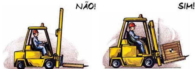
**Altura da carga:** não movimentar cargas com as forquilhas elevadas. A altura adequada das forquilhas sobre o chão é de 15 a 20 cm. Assim será mais difícil que o empilhador se vire.
